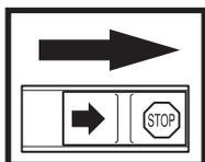
Couper le moteur avant tout contrôle ou réparation: bouton d'arrêt en position STOP.
