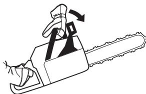
En position d'abattage, tenir la poignée avant de la main gauche ce qui ne permet pas d'activer manuellement le frein de chaîne. Dans cette position (la main gauche ne pouvant activer l'arceau de protection) le frein de chaîne ne peut être activé que par inertie.
