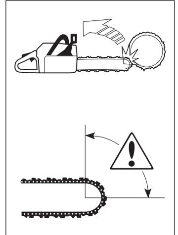
Le rebond se produit toujours dans le plan du guide-chaîne. En général, tronçonneuse et guide-chaîne sont relevés simultanément en direction de l'opérateur. Néanmoins, le direction du rebond peut varier suivant la position du nez au moment où il touche un objet quelconque.
