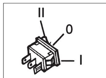
L'interrupteur est fermé en position « 0 »
