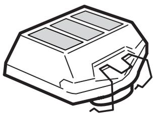
**IMPORTANT! Tout filtre endommagé doit être remplacé immédiatement.**
