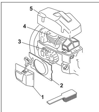
Une fois par semaine, nettoyer le système de refroidissement avec une brosse; dans les conditions sévères, plus souvent. **Un système de refroidissement sale ou colmaté provoque une surchauffe de la tronçonneuse, ce qui entraîne l'endommagement du cylindre et du piston.**
