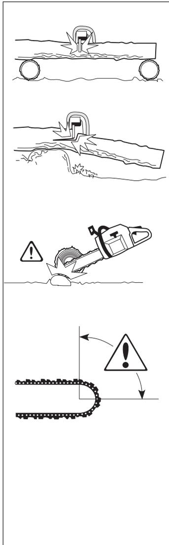
Si la chaîne se coince ou si la pièce à scier se casse, cela dépend de deux raisons : le support de la pièce avant et après le sciage, et l'état de tension de la pièce.
