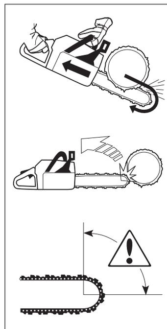
Il importe de résister à la poussée en arrière du guide-chaîne. En effet, si le guide-chaîne est repoussé assez en arrière pour que le nez se trouve à son tour engagé (zone dangereuse), un rebond peut se produire.
