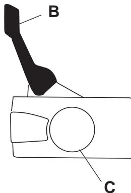
Ce mouvement active mécaniquement un ressort qui tend le ruban du frein (C) autour du système d'entraînement de la chaîne, autrement dit le "tambour d'embrayage" (D).
