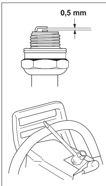
REMARQUE: Utiliser toujours le type de bougie recommandé! Une bougie incorrecte peut endommager le piston/le cylindre.
