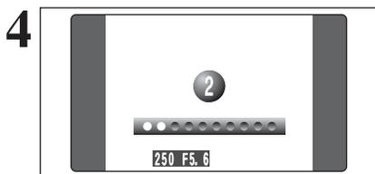
Un compte à rebours apparaît sur le moniteur LCD jusqu'à ce que la vue soit prise. Le mode photographie avec retardateur est annulé après chaque prise de vues.
