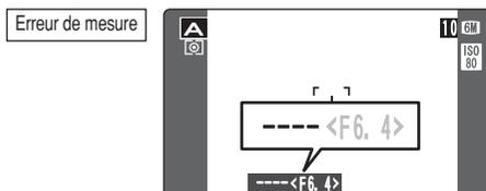
Lorsque la luminosité du sujet est en dehors de la plage de mesure de luminosité de l'appareil photo, "----" apparaît à l'écran en tant que réglage de la vitesse d'obturation. Dans ce cas, appuyez à mi-course sur le déclencheur pour mesurer de nouveau le niveau de lumière et afficher une valeur.
