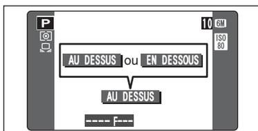
Lorsque "AU DESSUS" ou "EN DESSOUS" apparaît, la balance des blancs n'a pas été mesurée avec l'exposition correcte. Réglez de nouveau la compensation de l'exposition, en utilisant une valeur négative (-) lorsque "AU DESSUS" (surexposé) apparaît et une valeur positive (+) lorsque "EN DESSOUS" (sous-exposé) apparaît.
