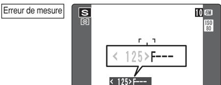
Lorsque la luminosité du sujet est en dehors de la plage de mesure de luminosité de l'appareil photo, "F---" apparaît à l'écran en tant que réglage d'ouverture. Dans ce cas, appuyez à mi-course sur le déclencheur pour mesurer de nouveau le niveau de lumière et afficher une valeur.
