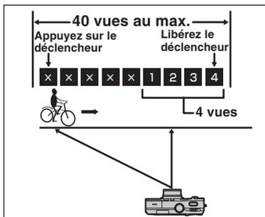
Ce mode vous permet de libérer le déclencheur jusqu'à 40 fois (maxi 3 vue/sec.) et d'enregistrer les 4 dernières vues. Si vous retirez votre doigt du déclencheur avant que les 40 vues aient été prises, l'appareil photo enregistre les 4 dernières vues prises avant le relâchement du déclencheur.
