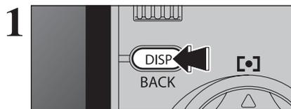
Pour prendre des photos avec le viseur, appuyez sur la touche "DISP (BACK)" pour éteindre le moniteur LCD. La mise hors tension du moniteur LCD permet d'économiser de l'énergie.
