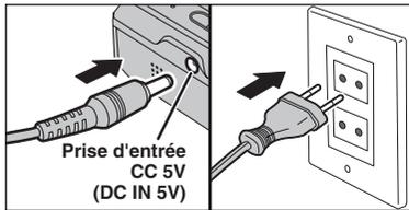
Vérifiez si l'appareil photo est hors tension. Branchez le connecteur de l'adaptateur secteur dans la prise d'entrée CC 5V de l'appareil et branchez ensuite l'adaptateur secteur dans la prise murale.
