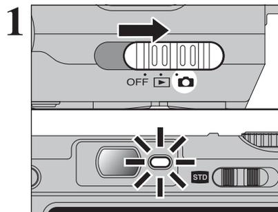
Déplacez l'interrupteur d'alimentation pour mettre l'appareil photo sous et hors tension. Lorsque vous mettez l'appareil sous tension, le témoin du viseur s'allume vert.
