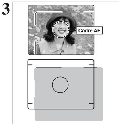
Cadrez la photo de façon à ce que le sujet remplisse entièrement le cadre AF (Autofocus). Lorsqu'une vue est prise à une distance comprise entre environ 0,6 m et 1,5 m utilisez le viseur, seule la zone ombrée de la figure est photographiée.
