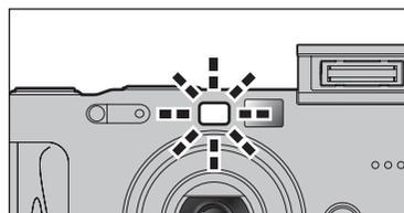
Appuyez à mi-course sur le déclencheur dans des conditions de faible éclairage. L'appareil photo déclenche le témoin d'assistance AF (vert) pour permettre d'effectuer plus facilement la mise au point.
