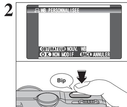
Maintenez une feuille de papier sous la source lumineuse pour régler la balance des blancs de façon à ce qu'elle remplisse le moniteur LCD et appuyez sur le déclencheur pour régler la balance des blancs.
