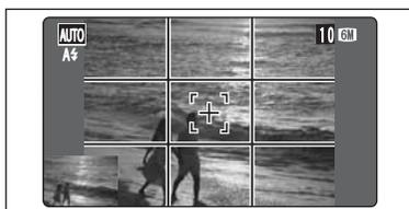
Lorsqu'une photo est prise alors que le guide de cadrage est affiché, l'image photographiée apparaît en bas à gauche du moniteur LCD (fenêtre d'assistance). Ceci sert de guide pour prendre d'autres photos avec des compositions identiques.
