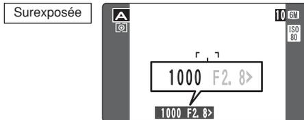
Dans des scènes extrêmement surexposées, la vitesse d'obturation (1/1000 sec.) apparaît en rouge. Lorsque cela se produit, sélectionnez un nombre plus élevé pour l'ouverture (jusqu'à F8).
