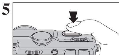
5 Appuyez à mi-course sur le déclencheur (verrouillage AF/AE) sans relâcher la touche, appuyez à fond sur le déclencheur pour prendre la vue. Ceci vous permet de réduire la durée de la mise au point.
