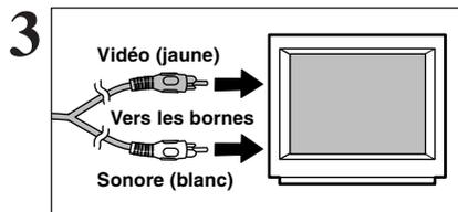
Branchez l'autre extrémité du câble dans la prise d'entrée audio/vidéo (A/V) du téléviseur.
