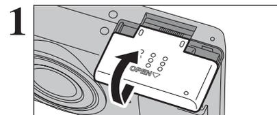
Vérifiez si l'appareil photo est hors tension (témoin du viseur éteint) avant d'ouvrir le couvercle du compartiment batterie.
