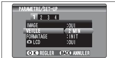
Lorsque cette fonction est activée, le moniteur LCD du moniteur s'éteint provisoirement et le témoin du viseur (vert) clignote à des intervalles d'une seconde afin de réduire la consommation d'énergie (mode de veille) si l'appareil photo n'est pas utilisé pendant 60 secondes. Si l'appareil photo reste inutilisé pendant 2 ou 5 minutes, il se met hors tension. Utilisez cette fonction lorsque vous désirez obtenir la durée d'utilisation maximum de votre batterie.
