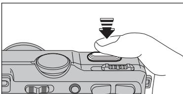
Lorsque l'appareil photo est mis en veille, la pression à mi-course sur le déclencheur redémarre l'appareil qui est alors prêt à prendre des vues.
