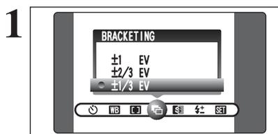
Utilisez ce réglage pour photographier une image identique avec différents réglages d'exposition. La fonction bracketing prend 3 vues consécutives, l'une étant correctement exposée, les deux photos restantes étant l'une sous-exposée et l'autre surexposée d'une quantité spécifiée.
