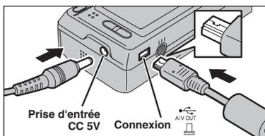
Branchez l'adaptateur secteur, le câble USB ou le câble A/V (fourni) à l'appareil photo directement.
