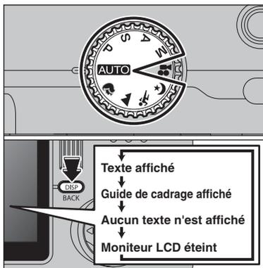
Sélectionner la fonction guide de cadrage en mode "AUTO", "A", "M", "S", "P", "C", "A", "S", "A" ou "M". Appuyez sur la touche "DISP (BACK)" pour changer l'affichage sur le moniteur LCD. Continuez à appuyer sur la touche "DISP (BACK)" jusqu'à ce que le "Guide de cadrage" apparaisse.
