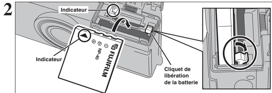
Déplacez du doigt le cliquet de libération de la batterie et introduisez la batterie comme le montre l'illustration. Assurez-vous que les bornes de la batterie sont face à la bonne direction. Vérifiez si la batterie est bien maintenue en place.
