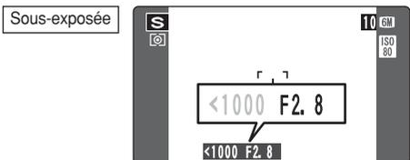
Dans des scènes extrêmement sous-exposées, le réglage d'ouverture (F2,8) apparaît en rouge. Dans ce cas, sélectionnez une vitesse d'obturation plus lente (diminution jusqu'à 3 sec.).
