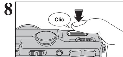
Appuyez à fond sur le déclencheur sans le relâcher. Lorsqu'un déclic est entendu, l'appareil enregistre l'image.
