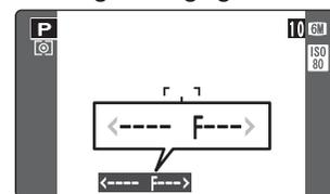
Lorsque la luminosité du sujet est en dehors de plage de mesure de luminosité de l'appareil photo, "..." apparaît au moniteur LCD en tant que réglage de la vitesse d'obturation et de l'ouverture.
