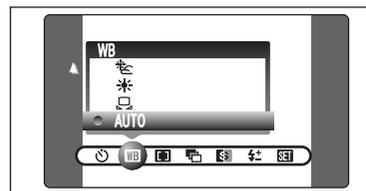
Modifiez le réglage de la balance des blancs pour prendre une vue avec la balance des blancs fixe pour l'environnement et l'éclairage.
