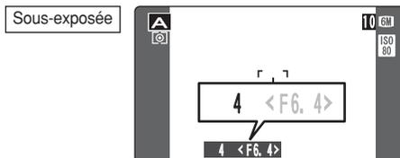
Dans des scènes extrêmement sous-exposées, la vitesse d'obturation (1/4 sec.) apparaît en rouge. Dans ce cas, sélectionnez une ouverture plus petite.
