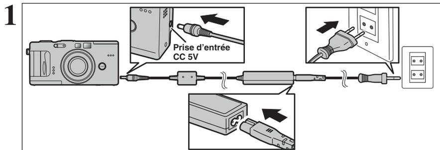
Assurez-vous que l'appareil photo est hors tension. Branchez le connecteur de l'adaptateur secteur dans la prise d'entrée CC 5V de l'appareil photo et branchez ensuite l'adaptateur lui-même dans une prise de courant.
