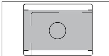
Lorsqu'une vue est prise à une distance comprise entre 1,5 m et l'infini seule la zone ombrée du viseur est photographiée.
