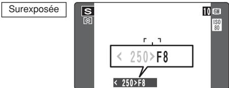
Dans des scènes extrêmement surexposées, le réglage d'ouverture (F8) apparaît en rouge. Dans ce cas, sélectionnez une vitesse d'obturation plus rapide (jusqu'à 1/1000 sec.).
