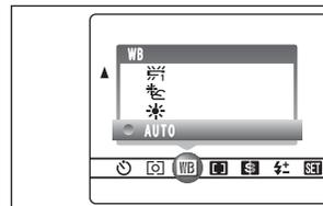
Modifiez le réglage de la balance des blancs pour prendre une vue avec la balance des blancs fixe pour l'environnement et l'éclairage.
