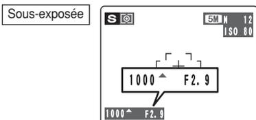
Dans des scènes extrêmement sous-exposées, le réglage d'ouverture (F2,9) apparaît en rouge. Dans ce cas, sélectionnez une vitesse d'obturation plus lente (diminution jusqu'à 2 sec.).
