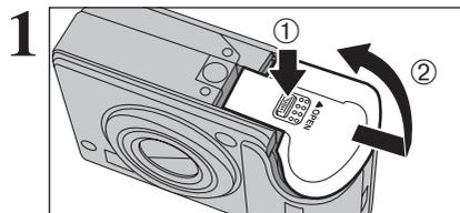
Vérifiez si l'appareil photo est hors tension (témoin du viseur éteint) avant d'ouvrir le couvercle du compartiment piles.
