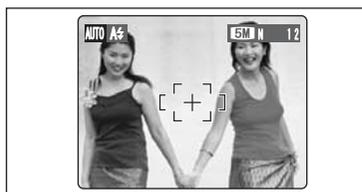
Dans une photo, les sujets (deux personnes dans ce cas) ne sont pas dans le cadre AF. Si la vue est prise à ce moment-là, les sujets ne seront pas mis au point.
