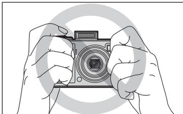
Maintenez l'appareil photo en faisant attention à ce que vos doigts ou la dragonne ne recouvrent pas l'objectif, le flash ou le détecteur de commande du flash. Si l'objectif, le flash ou le détecteur de commande du flash est obstrué, vous risquez de ne pas obtenir la luminosité (exposition) correcte pour votre photo.
