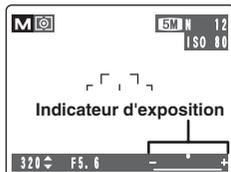
Utilisez l'indicateur d'exposition sur le moniteur LCD comme guide pour régler l'exposition.
