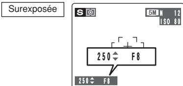
Dans des scènes extrêmement surexposées, le réglage d'ouverture (F8) apparaît en rouge. Dans ce cas, sélectionnez une vitesse d'obturation plus rapide (jusqu'à 1/1000 sec.).
