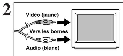
Branchez l'autre extrémité du câble dans la prise d'entrée vidéo du téléviseur. Mettez ensuite l'appareil photo et le téléviseur sous tension et procédez à lecture des images comme vous le faites normalement.
