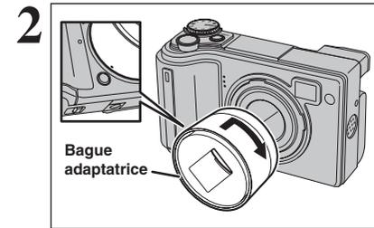
Réglez l'indicateur de la bague adaptatrice sur la position de la touche de libération de la bague adaptatrice. Fixez la bague adaptatrice en la visant dans la direction de la flèche jusqu'à ce qu'il s'arrête.
