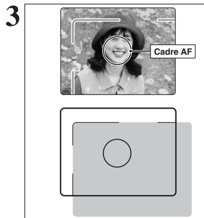
Cadrez la photo de façon à ce que le sujet remplisse entièrement le cadre AF (Autofocus). Lorsqu'une vue est prise à une distance comprise entre 0,6 m et 1,5 m en utilisant le viseur optique seule la zone ombrée du cadre est photographiée.
