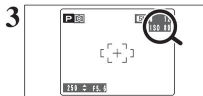
Lorsque la sensibilité est réglée sur "80", "100", "200" ou "400" le réglage apparaît sur le moniteur LCD.
