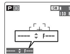
Lorsque la luminosité du sujet est en dehors de plage de mesure de luminosité de l'appareil photo, "..." apparaît au moniteur LCD en tant que réglage de vitesse d'obturation et d'ouverture.
