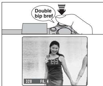
Appuyez à mi-course sur le déclencheur (verrouillage AF/AE). L'appareil photo émet un bref double bip et effectue la mise au point sur le sujet. Le cadre AF sur moniteur LCD devient plus petit et l'appareil photo règle la vitesse d'obturation et l'ouverture. Le témoin du viseur (vert) s'arrête de clignoter et reste allumé.
