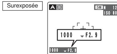
Dans des scènes extrêmement surexposées, la vitesse d'obturation (1/1000 sec.) apparaît en rouge. Lorsque cela se produit, sélectionnez un nombre plus élevé pour l'ouverture (jusqu'à F8).
