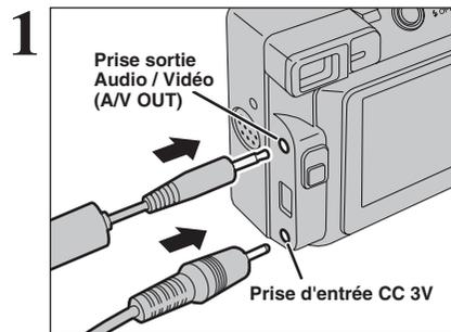
Mettez l'appareil photo et le téléviseur hors tension. Branchez le câble A/V (fourni) dans la prise sortie audio/video (A/V OUT).
