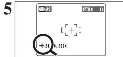
Lorsque le mode photographie est sélectionné avec l'heure mondiale réglée, “+” apparaît sur le moniteur LCD pendant 3 secondes.
