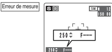
Lorsque la luminosité du sujet est en dehors de la plage de mesure de luminosité de l'appareil photo, "F---" apparaît à l'écran en tant que réglage d'ouverture. Dans ce cas, appuyez à mi-course sur le déclencheur pour mesurer de nouveau le niveau de lumière et afficher une valeur.
