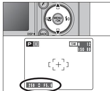
Appuyez sur "▲" ou "▼" pour sélectionner différentes combinaisons de réglage pour la vitesse d'obturation et l'ouverture, sans changer le réglage d'exposition. Le réglage de la vitesse d'obturation et celui de l'ouverture apparaissent en jaune lorsque l'appareil photo est en mode déplacement de programme.
