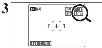
Lorsque le réglage en mode F-DIAPO ou en mode F-N&B, l'icône apparaît au moniteur LCD.
