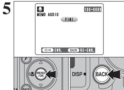
Après 30 secondes d'enregistrement, "FINI" apparaît sur le moniteur LCD.
