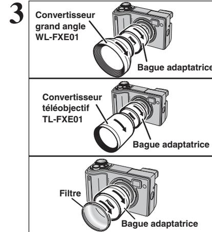
Montez l'objectif de conversion ou les filtres commerciaux sur la bague adaptatrice.
