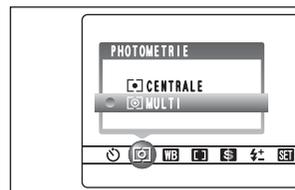
Utilisez ce réglage pour les scènes où la luminosité du sujet et de l'environnement est très différente, et qu'il est par conséquent difficile d'obtenir le résultat désiré avec le réglage MULTI.
