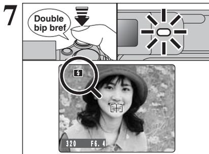
Appuyez à mi-course sur le déclencheur. L'appareil photo émet un bref double bip et effectue la mise au point sur le sujet. Le cadre AF sur le moniteur LCD devient plus petit et l'appareil photo règle la vitesse d'obturation et l'ouverture. Le témoin du viseur (vert) s'arrête de clignoter et reste allumé.
