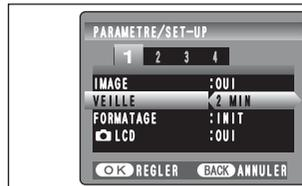
Lorsque cette fonction est activée, le moniteur LCD de l'appareil photo s'éteint provisoirement et le témoin du viseur (vert) clignote à des intervalles d'une seconde afin de réduire la consommation d'énergie (mode de veille) si l'appareil photo n'est pas utilisé pendant 2 ou 5 minutes, il se met hors tension. Utilisez cette fonction lorsque vous désirez obtenir la durée d'utilisation maximum de votre batterie.
