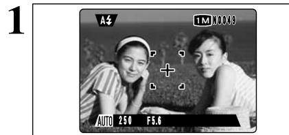
Dans une photo avec ce genre de composition, les sujets (deux personnes dans ce cas) ne sont pas dans le cadre AF. Si la photo est prise à ce moment-là, les sujets ne seront pas mis au point.
