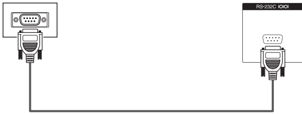
Câble série de commande RS-232C (de type croisé, en vente dans le commerce)
