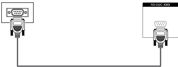
Câble série de commande RS-232C (de type croisé)
