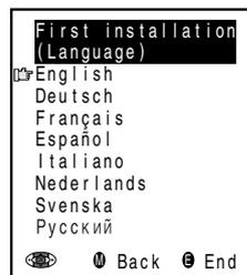
**2** Appuyer sur ▲/▼ pour choisir la langue souhaitée, puis sur **OK**. La page-écran "Première mise en service (Recherche automatique)" apparaît dans la langue sélectionnée.
