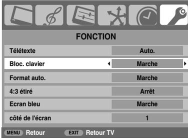
Lorsque le **Bloc. clavier** est en **Marche**, un rappel apparaîtra à l'écran si vous tentez d'utiliser les touches du téléviseur. **Si vous appuyez sur la touche de veille, le téléviseur s'éteindra et ne pourra être rallumé qu'en utilisant la télécommande.**
