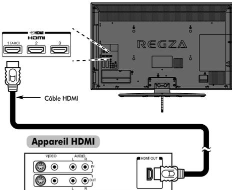
Pour visualiser le signal vidéo de l'appareil HDMI, appuyez sur la touche pour sélectionner le mode HDMI 1, HDMI 2, HDMI 3 ou HDMI 4.
