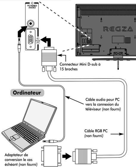
Pour utiliser un PC, réglez la résolution de sortie du moniteur de l'ordinateur avant de le raccorder au téléviseur. Pour connaître les formats de signaux PC pris en charge, voir page 74.
