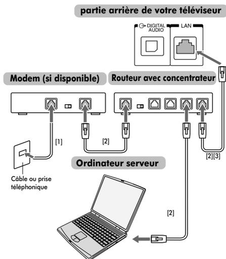
[1] Câble coaxial ou téléphonique (selon le type de modem utilisé)
