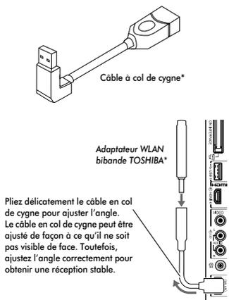
\* L'adaptateur WLAN bibrande TOSHIBA et le câble en col de cygne sont fournis avec les modèles VL, mais pas avec les modèles SL.
