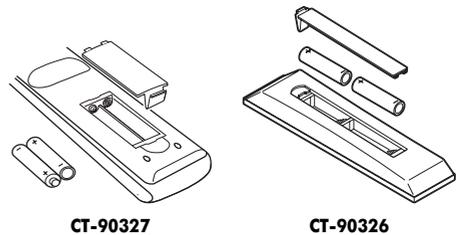
Retirez le cache arrière pour ouvrir le compartiment des piles et assurez-vous d'insérer les piles correctement en respectant les polarités. Des types de piles appropriés pour cette télécommande sont AAA, IEC R03 1,5 V.
