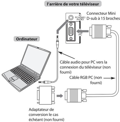
Pour utiliser un PC, réglez la résolution de sortie du moniteur de l'ordinateur avant de le raccorder au téléviseur. Pour connaître les formats de signaux PC pris en charge, voir page 73.
