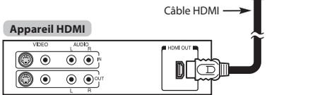
Pour visualiser le signal vidéo de l'appareil HDMI, appuyez sur la touche
