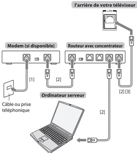
[1] Câble coaxial ou téléphonique (selon le type de modem utilisé)
