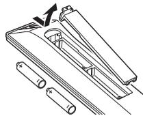
Retirez le cache arrière pour ouvrir le compartiment des piles et assurez-vous de bien respecter les polarités. Les types de piles appropriés pour cette télécommande sont AAA, IEC R03 1,5 V.
