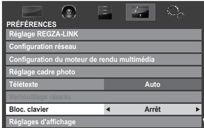
Lorsque la fonction **Bloc. clavier** est définie sur **Marche**, un message de rappel apparaît à l'écran si vous tentez d'utiliser les touches du téléviseur. **Si vous appuyez sur la touche de veille, le téléviseur s'éteindra et ne pourra être rallumé qu'en utilisant la télécommande.**
