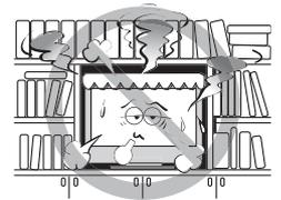
Les fentes et orifices sont destinés à assurer la ventilation du téléviseur de manière à ce qu'il fonctionne sans anomalie. Laisser un espace d'au moins 4 (quatre) pouces autour du téléviseur.
