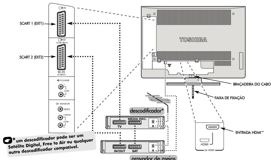
**Antes de ligar os cabos da antena, do vídeo e do sistema áudio, retire as tampas laterais e traseiras dos terminais apertando a patilha e puxando as tampas para fora.**
