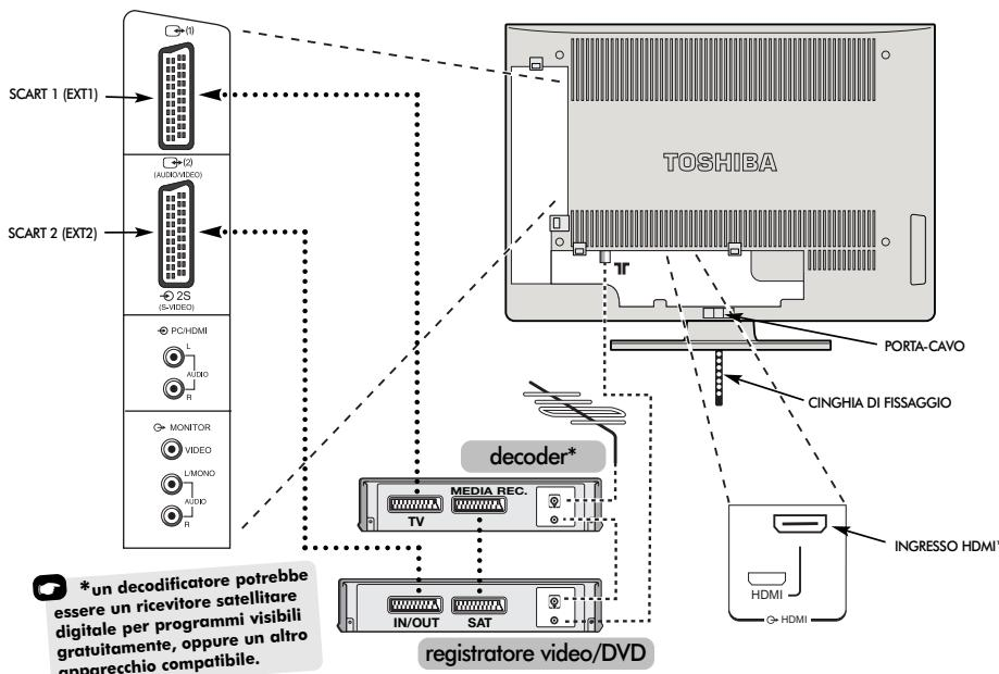
**Prima di collegare il cavo dell'antenna, del videoregistratore e dell'audio, rimuovere sia il coperchio laterale che quello posteriore dei terminali strizzando la linguetta e tirandolo via.**
