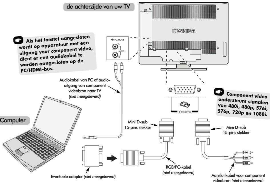
Sluit de PC-kabel van de computer aan op de PC-aansluiting aan de achterzijde van de TV.
