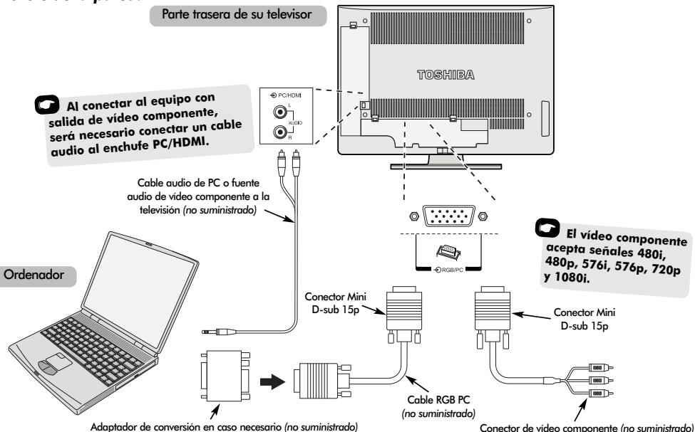
Conecte el cable de PC del ordenador al terminal PC en la parte trasera de la televisión.
