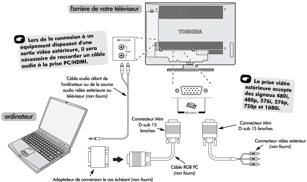
Connectez le câble d'ordinateur de l'ordinateur à la borne PC à l'arrière du téléviseur.
