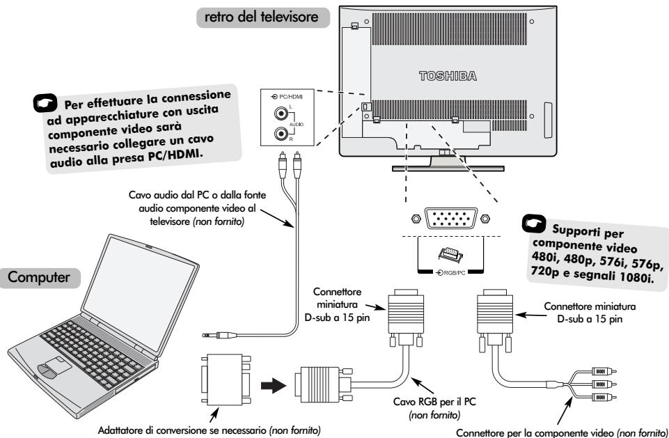
Collegare il cavo del PC proveniente dal computer al terminale PC sul retro del televisore.
