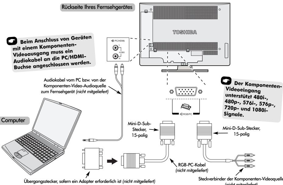
Verbinden Sie das PC-Kabel des Computers mit dem PC-Anschluss an der Rückseite des Fernsehgerätes.
