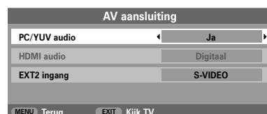
**OPMERKING:** Door het selecteren van **PC/YUV audio** zal HDMI automatisch worden ingesteld op digitale geluidsweergave.
