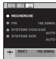
**6** Si vous souhaitez utiliser le réglage fin. Sélectionner **FIN** et appuyer sur **ENTER**. Appuyer sur ◀ ou sur ▶ pour régler. Voir la remarque sur cette page.
