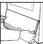
2. Oba vzvoda, ki zadržujejo kondenzator, obrnite v nasprotni smeri urnega kazalca in izvlecite kondenzator.
