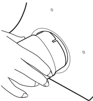
Il est essentiel d'utiliser un tuyau de ventilation pour évacuer l'air chaud humide du sèche-linge sauf si celui-ci se trouve dans un espace ouvert disposant d'une bonne circulation d'air. Une reprise de l'air humide réduit l'efficacité du sèche-linge.
