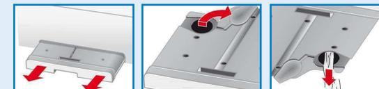
Contrôlez que le clapet du réservoir d'eau de condensation ne présente pas d'impuretés: Si des peluches se sont déposées sur le clapet → rincez le clapet sous l'eau du robinet. Mettez un peu d'eau du robinet dans le réservoir d'eau de condensation vide puis videz-la par le clapet.
