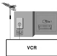
1. Raccordez la sortie RF du magnéscope à la prise d'antenne située à l'arrière du téléviseur.
