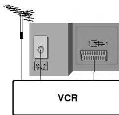
1. Raccordez la prise Péritel du magnéscope au connecteur Péritel à l'arrière du téléviseur.
