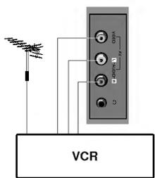
1. Raccordez les prises de sortie audio et vidéo du magnéscope aux prises d'entrée audio/vidéo du téléviseur.
