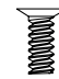
Viti del supporto 4EA, M4 x L10 (Solo EA88**-ZA) (Vedere pag. A-3)
