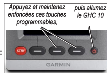
Procédure d'allumage pour configuration avancée
