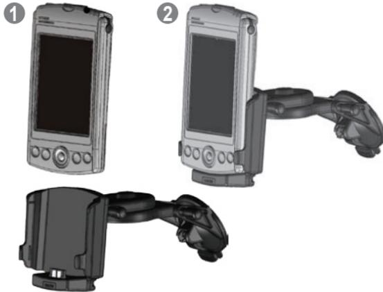
6. Desserrez les boutons de réglage et repositionnez le support si possible, de manière à pouvoir voir l'iQue M5 facilement. Lorsque vous avez terminé de régler le montage, serrez fermement les boutons et vérifiez le bon maintien du support ventouse.
