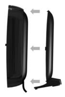
Insérer le couvercle dans les encoches à l'arrière de la base (à ne pas faire en cas de montage mural).
