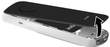
Pour **changer la batterie**, insérer un ongle dans l'encoche du boîtier et tirer la batterie vers le haut.
