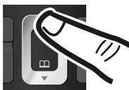
Pour modifier une entrée, appuyer sur la partie supérieure ou inférieure de la touche de navigation pour passer d'un champ à un autre.
