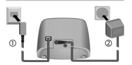
Raccorder la fiche du téléphone et le cordon téléphonique ① et le bloc secteur (230 V) au cordon électrique ② comme indiqué. Placer les cordons dans les rainures. Les deux cordons doivent toujours être insérés.
