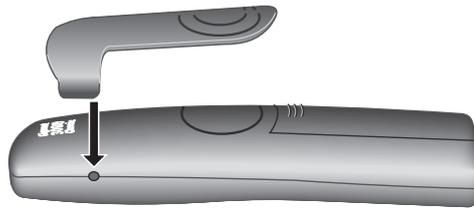
Placer le clip ceinture à l'arrière du combiné et appuyer jusqu'à ce que les ergots s'enclipsent dans les trous disposés latéralement.
