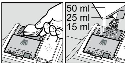
2. Poussez le couvercle du compartiment à détergent vers le haut jusqu'à ce que la fermeture encrante bien.
