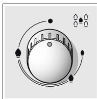
La flamme visible sur le bouton de commande du brûleur à wok indique la position à partir de laquelle le cercle extérieur de flammes est allumé.
