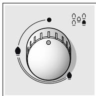
Die Markierungen am Drehknopf zeigen die Zuordnung zum jeweiligen Brenner und die Einstellung von Kleinbrand bis Vollbrand an. Die Einstellung ist stufenlos.
