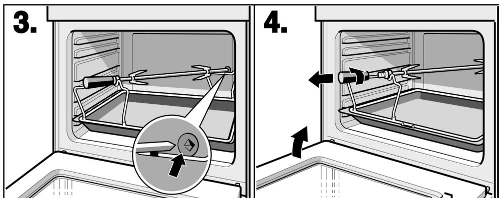
3. Enfouissez la lèchefrite au niveau 1. Un orifice a été ménagé dans la paroi arrière du four. Faites-y encranter l'extrémité du tournebroche.
