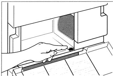
Il est important d'enlever les dépôts sur toute la surface du logement du condenseur ainsi que ceux accumulés autour du trou d'évacuation de l'eau.
