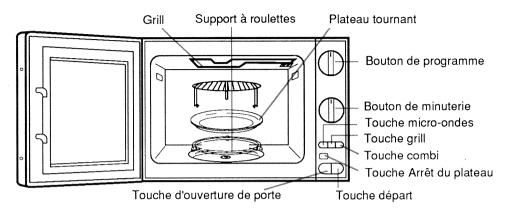
LE PLATEAU TOURNANT permet une cuisson homogène de l'aliment sans manipulation. Il est guidé dans sa rotation par l'axe d'entraînement et le support à roulettes, il tourne indifféremment dans les deux sens. S'il ne tourne pas, vérifiez que tous les éléments sont bien positionnés. Il peut être utilisé comme plat de cuisson. Pour le retirer, appuyez sur le bord extérieur.
