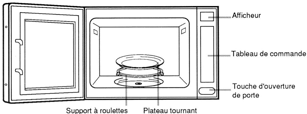
**LE PLATEAU TOURNANT** permet une cuisson homogène de l'aliment sans manipulation. Il est guidé dans sa rotation par l'axe d'entraînement et le support à roulettes, il tourne indifféremment dans les deux sens. S'il ne tourne pas, vérifiez que tous les éléments sont bien positionnés. Il peut être utilisé comme plat de cuisson. Pour le retirer, appuyez sur le bord extérieur.
