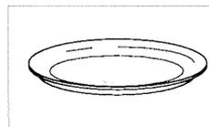
**L'ARRET DU PLATEAU** permet d'utiliser des grands plats sur toute la surface du four. Dans ce cas, il est nécessaire de tourner le plat ou de mélanger à mi-cuisson. Pour obtenir cette fonction, sélectionnez la touche "arrêt du plateau", après la programmation et avant l'appui sur la touche "départ".
