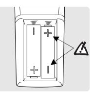
2 Insérer les batteries en respectant les polarités (+ et -).
