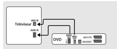
Pour un téléviseur mono utiliser un cordon audio special en forme de «Y» (non fourni).
