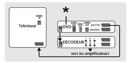
\* En fonction de votre équipement, vous pouvez utiliser la sortie coaxiale ou optique pour raccorder le lecteur au décodeur.
