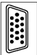
Raccordez le connecteur D-sub sur le côté gauche du TV LCD au connecteur de sortie du signal composite de votre appareil audiovisuel au moyen d'un câble spécial.
