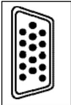
Branchez une extrémité d'un câble mini D-sub 15 broches au connecteur D-sub situé sur le côté gauche du TV LCD et l'autre extrémité du câble à la sortie du PC (voir illustration).
