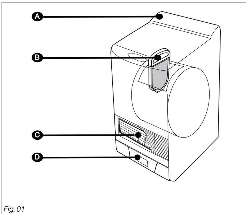
**A** *Tableau de commande***C** *Grille condenseur***B** *Filtre***D** *Bac de récupération d'eau*
