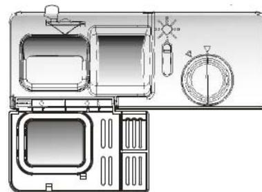
Les distributeurs de détergent et de liquide de rinçage sont situés du côté intérieur de la porte: le **distributeur de détergent** à gauche et le **distributeur de liquide de rinçage** à droite.
