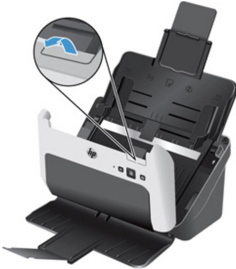
3. Nettoyez les bandes avec un chiffon doux non pelucheux imbibé d'eau distillée ou d'eau du robinet propre.
