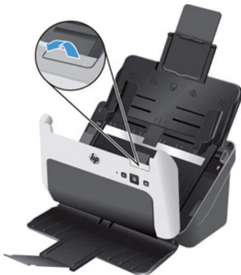
3. À l'arrière du chargeur de documents ouvert, introduisez un ongle sous l'ergot situé sur la partie supérieure droite du capot de protection des rouleaux d'alimentation, puis saisissez fermement l'ergot et tirez-le vers l'avant afin d'ouvrir le capot et exposer les rouleaux d'alimentation supérieurs.
