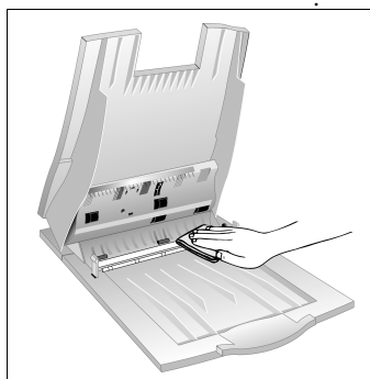
Nettoyage de la fenêtre du BAA
