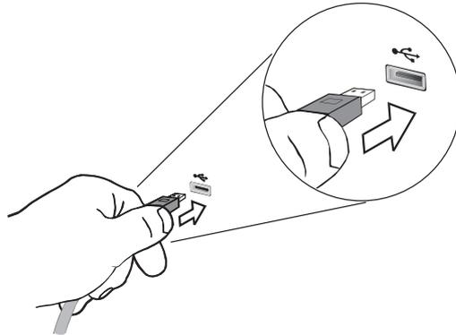
5. Connectez l'extrémité carrée du câble d'interface USB au connecteur USB situé à l'arrière du scanner de photos. (Le connecteur USB se trouve à droite du connecteur d'alimentation à l'arrière du scanner de photos.)
