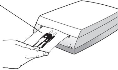
3. Poussez doucement le tirage dans le logement jusqu'à ce que la lumière du scanner s'allume et que le scanner de photos entraîne le tirage.
