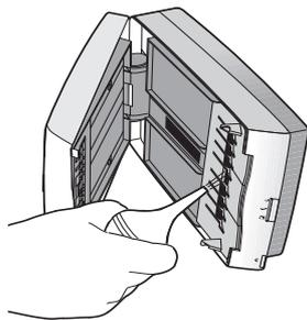
5. Utilisez l'injecteur d'air pour chasser la poussière de la longue vitre en verre située dans la partie supérieure avant du scanner de photos.
