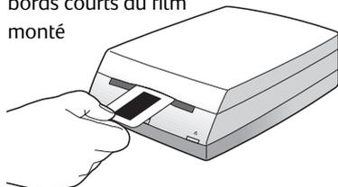
4. Poussez doucement le film monté dans le logement jusqu'à ce que la lumière du scanner s'allume et que le scanner de photos entraîne le film monté.
