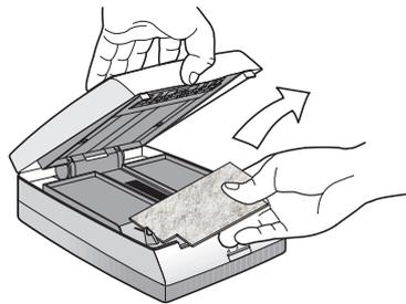
6. Fermez le couvercle du scanner de photos en appuyant fermement jusqu'à entendre un déclic.
