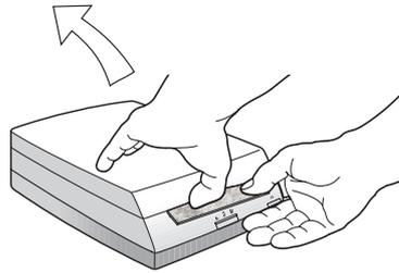
5. Soulevez délicatement le couvercle du scanner de photos et retirez l'élément en mousse.
