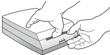
2. Soulevez avec précaution le couvercle du scanner de photos de 5 cm et retirez la photographie. Veillez à ne toucher aucune des fenêtres en verre situées à l'intérieur du scanner de photos.
