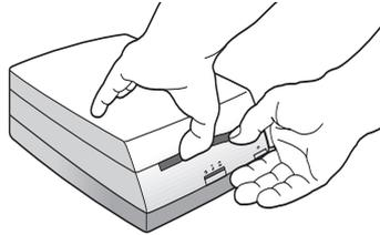
3. Soulevez avec précaution le couvercle du scanner de photos de 7,5 cm environ et posez le scanner sur le côté sur une surface plate.
