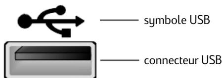
4. Connectez l'extrémité rectangulaire du câble d'interface USB au connecteur USB situé à l'avant ou l'arrière (extérieur) de l'ordinateur.
