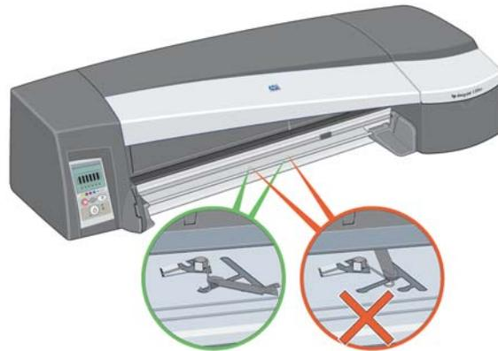
A l'intérieur du logement du bac, vous trouverez trois loquets à ressort. S'ils ne sont pas bien en place, le bac ne peut pas être inséré correctement.
