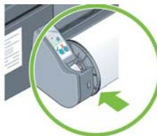
7. Introduisez le bord avant du papier dans l'alimentation arrière de l'imprimante jusqu'à ce qu'il rencontre une résistance. Veillez à ce que les bords restent bien enroulés afin que le papier reste bien aligné.
