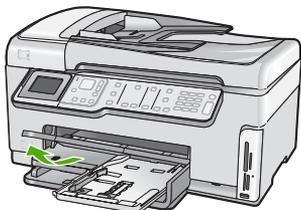
2. Insérez la pile de papier photo dans le bac d'alimentation photo dans le sens de la longueur et face papier glacé vers le bas. Faites-la glisser jusqu'à ce qu'elle soit calée. Si le papier photo utilisé est perforé, chargez-le de manière à ce que les perforations soient le plus près de vous.
