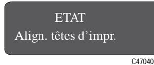
L'imprimante aligne les têtes d'impression en imprimant et en étalonnant le motif multicolore.
