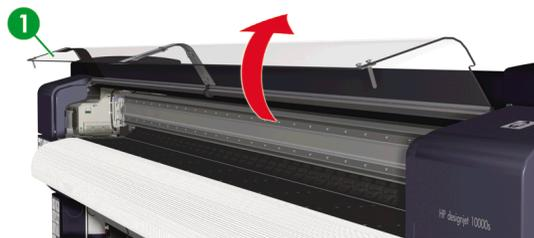
7. Déplacez les guides de largeur du support (1) vers chaque extrémité du cylindre afin qu'ils ne soient pas masqués sous le support.
