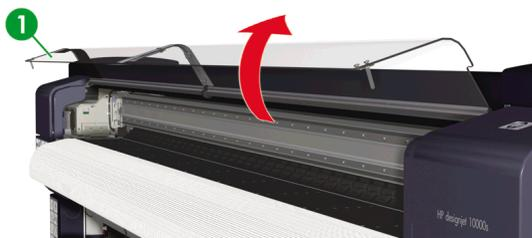
13. Déplacez les guides de largeur du support (1) vers chaque extrémité du cylindre afin qu'ils ne soient pas masqués sous le support.
