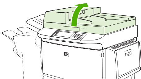
Figure 11-17 Nettoyage des rouleaux du bac BAA (1 sur 6)
