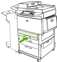
Figure 6-9 Chargement des bacs 2, 3 et 4 (6 sur 6)
