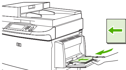
Figure 6-2 Chargement du bac 1 (2 sur 3)
