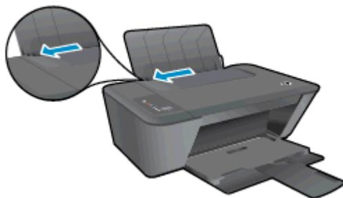
4. Insérez la pile de papier photo dans le sens de la longueur et face à imprimer vers le haut. Faites-la glisser jusqu'à ce qu'elle soit calée.
