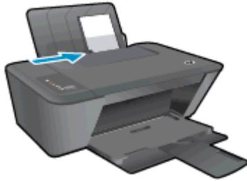
5. Faites glisser le guide de largeur vers la droite jusqu'à ce qu'il entre en contact avec le bord du papier.
