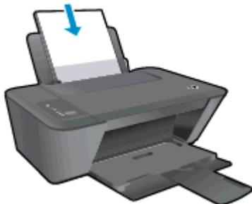
5. Faites glisser le guide de largeur vers la droite jusqu'à ce qu'il entre en contact avec le bord du papier.
