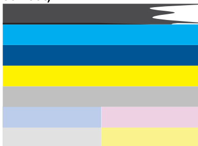
Figure 12-2 Barres de couleur : barre irrégulière ou teinte délavée (barre du haut)
