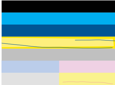
Figure 11-3 Barres de couleur : mélange de couleurs (la barre jaune comporte des stries de couleur magenta)
