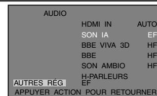
**AUTO** : La sélection numérique-analogique est automatique et dépend du signal d'entrée.
