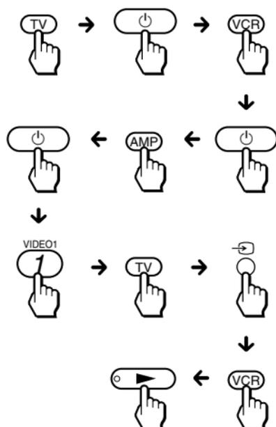
Vous pouvez programmer jusqu'à 16 étapes consécutives sur chacune des touches SYSTEM CONTROL (A – D), y compris l'étape initiale qui consiste à appuyer sur la touche de sélection d'appareil.
