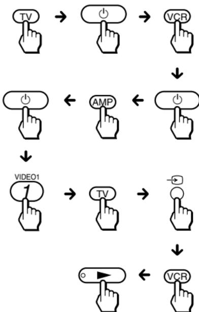
Vous pouvez programmer jusqu'à 16 étapes consécutives sur chacune des touches de sélection d'appareil, y compris l'étape initiale qui consiste à sélectionner une touche de sélection d'appareil.
