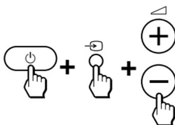
Lorsque vous appuyez sur la touche et sur la touche , toutes les touches de sélection d'appareil s'éteignent. Lorsque vous appuyez sur la touche - tout en maintenant les touches et enfoncées, l'indicateur SET s'allume et les touches de sélection d'appareil s'allument une par une. Lorsque l'indicateur SET s'éteint enfin, tous les réglages sont effacés et la télécommande revient à son état d'origine.
