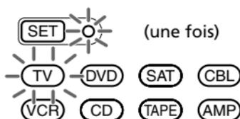
Lorsque la fonction de verrouillage est activée, aucune fonction ne peut être activée. (La indicateur SET et la touche de sélection d'appareil sélectionnée clignotent deux fois.)
