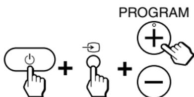
La indicateur SET et la touche de sélection d'appareil actuellement sélectionnée clignotent une fois, puis la fonction de verrouillage est activée.
