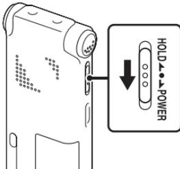
Schuif de HOLD/POWER-schakelaar langer dan 1 seconde in de richting "POWER". De IC-recorder wordt ingeschakeld, en "Accessing..." verschijnt.
