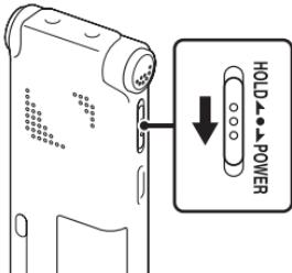
Faites glisser le commutateur HOLD/POWER dans le sens de « POWER » pendant au moins 1 seconde. L'enregistreur IC est mis sous tension, et « Accessing... » s'affiche.
