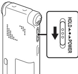
Far scorrere l'interruttore HOLD/POWER in direzione “POWER” per almeno 1 secondo. Il registratore IC si accende e viene visualizzato “Accessing...”.
