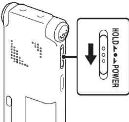
Deslize o interruptor HOLD/POWER na direcção de “POWER” durante mais de 1 segundo. O gravador de IC liga-se e é apresentado “Accessing...”.
