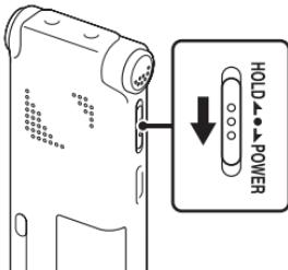
Deslice el interruptor HOLD/POWER en el sentido de “POWER” durante más de 1 segundo. La grabadora IC se enciende y se muestra “Accessing...”.
