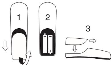
Votre combiné est alimenté par 2 batteries rechargeables AA/R6. En cas de remplacement, vous devez utiliser les batteries PHILIPS R6 NC-P ou Saft RC6.
